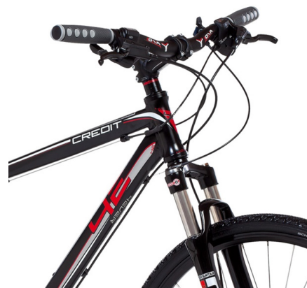
dvě na sobě nezávislé brzdy – přední a zadní a zaslepené konce řídítek 12
